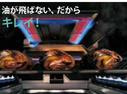
スリットから飛び散る油は800°Cのバーナーで焼き切れます。
